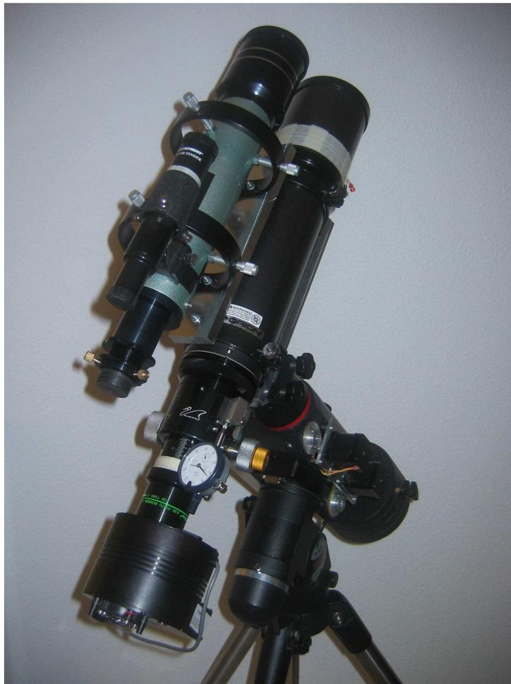
*Figure 11 : configuration d'autoguidage avec lunette guide et CCD Sbig ST-2000 XM*
