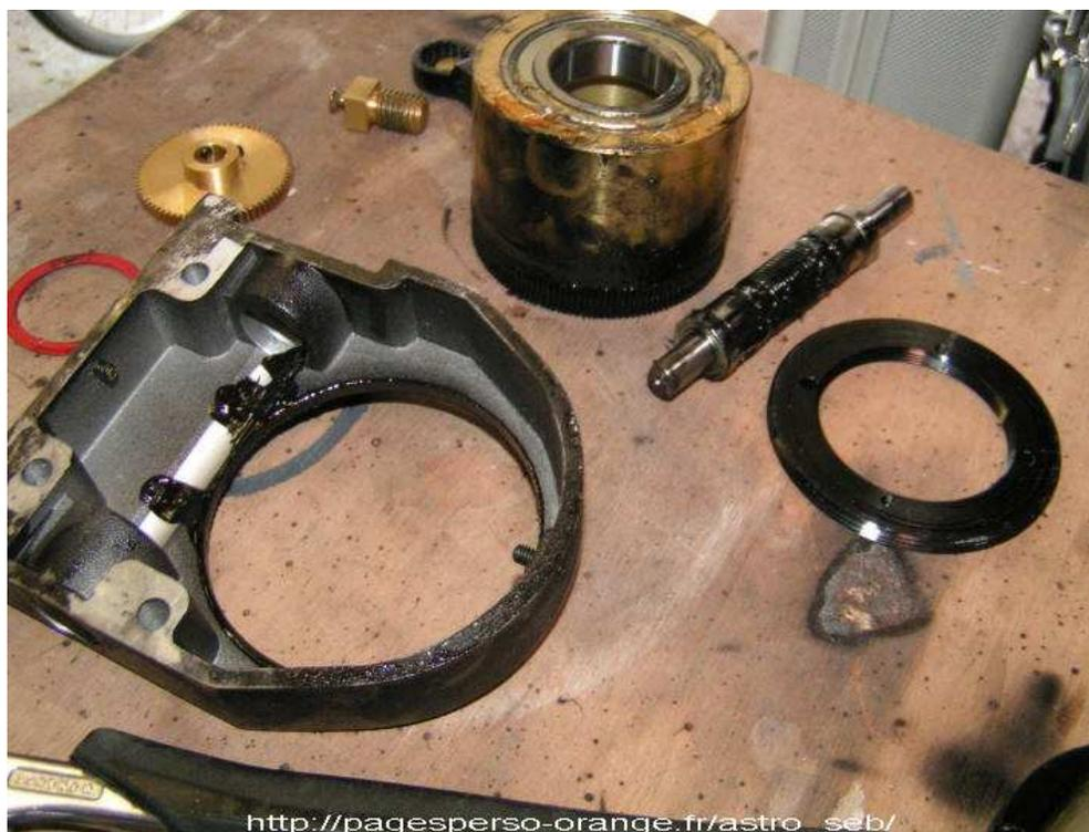
Figure 4 : aspect des roue dentée et VSF après démontage
